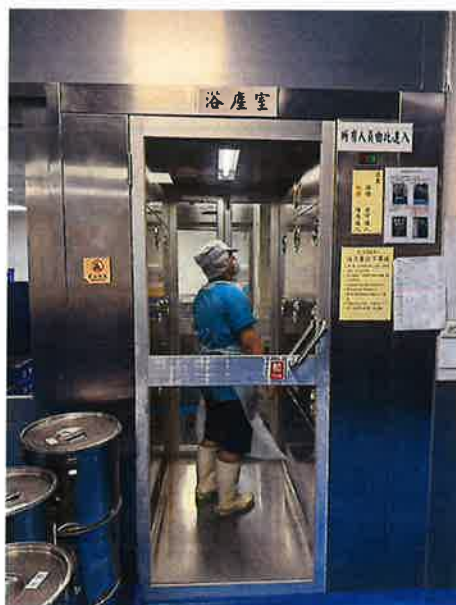
設有浴塵室，員工須由此進入烹調區
