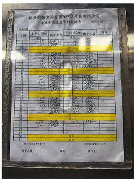
冷凍區溫度紀錄表 溫度應低於-18 度 C 以下，符合規定
